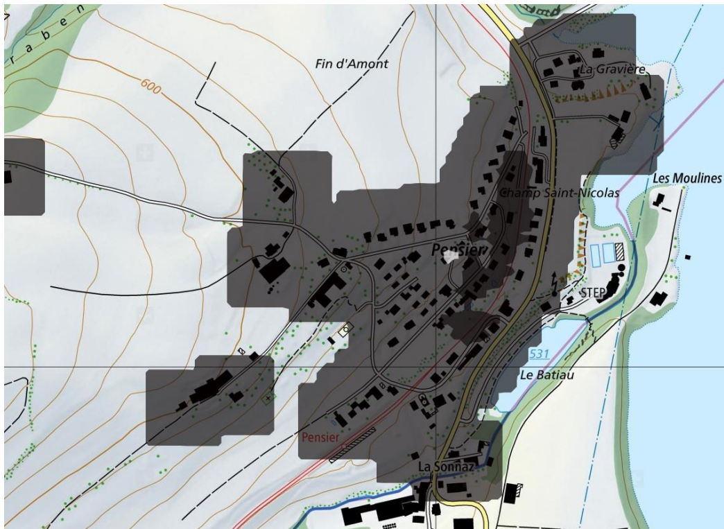
Figure 13 : Densité énergétique sur le territoire communal dans la zone de Pensier, ne prenant en compte que les habitations. Les zones en gris ont des besoins de chaleur, celle en gris foncé a un besoin moyen de 130 MWh/ha/an (très inférieur au minimum de 350 MWh/ha/an pour une énergie de réseau). Source : RegBL
