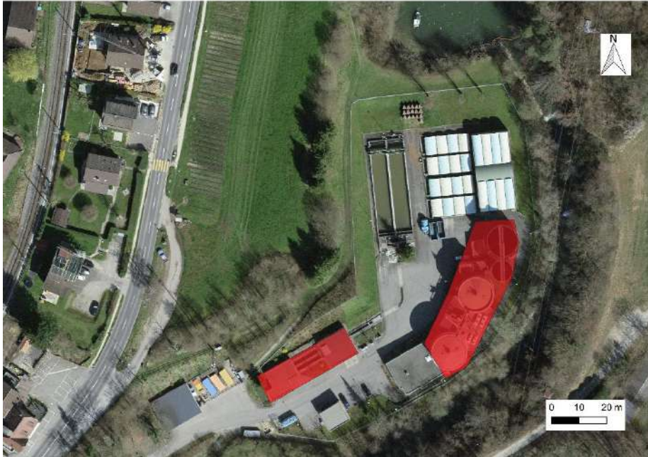
Figure 12 : Principales zones sources d'odeurs identifiées sur la STEP actuelle
