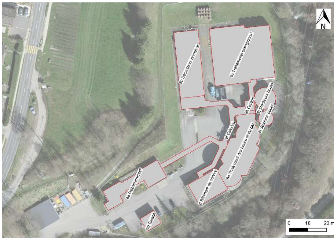
Figure 2: Site et ouvrages actuels de la STEP
